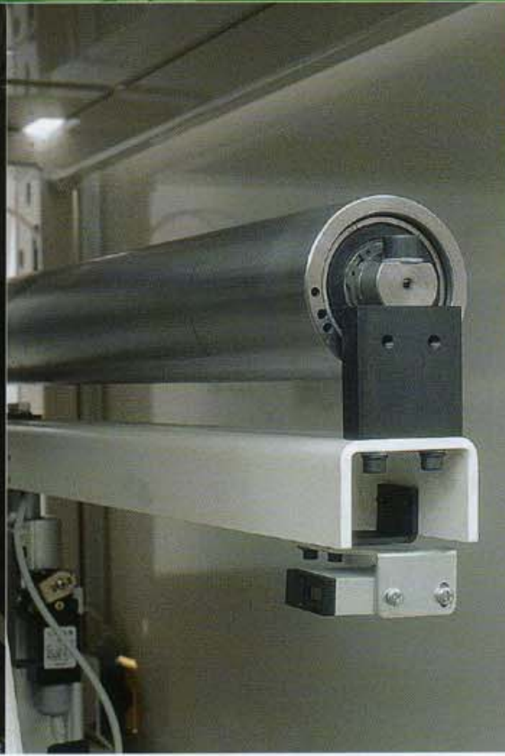
Umlenkrolle Schleifaggregat mit Oszillation Top roller belt unit with oscillation
